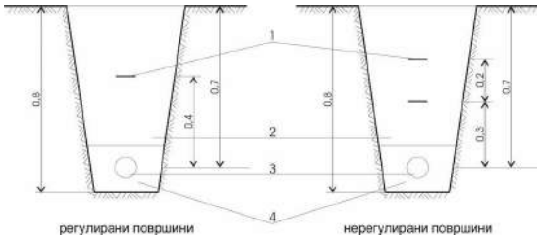
1 предупредувачка лента; 2 набиена земја во слоеви; 3 кабел; 4 песок сл. 1
